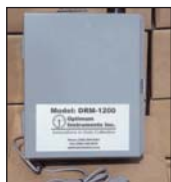
Le DRM-1200 Wireless Datalogger élimine le besoin d'installations permanentes sur place, avec branchements téléphoniques, bloc d'alimentation et système de chauffage.
