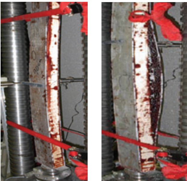
Décollement en phase et en discordance de phase de poutres en FRP/Glam
